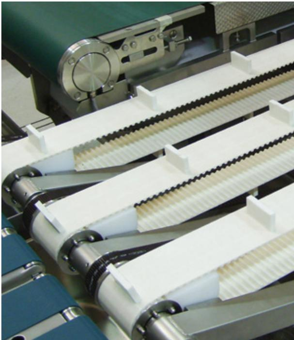
Die Anforderungen an Transportzahnriemen in der Holzverarbeitenden Industrie sind ebenso vielfältig, wie die Industriezweige, in denen Sie eingesetzt werden: von Holzsortiermaschinen, Zugsägenzuführungen über Laminattransport, bis hin zur Furnierbearbeitung leisten HabaSYNC® Zahnriemen wertvolle Dienste.
