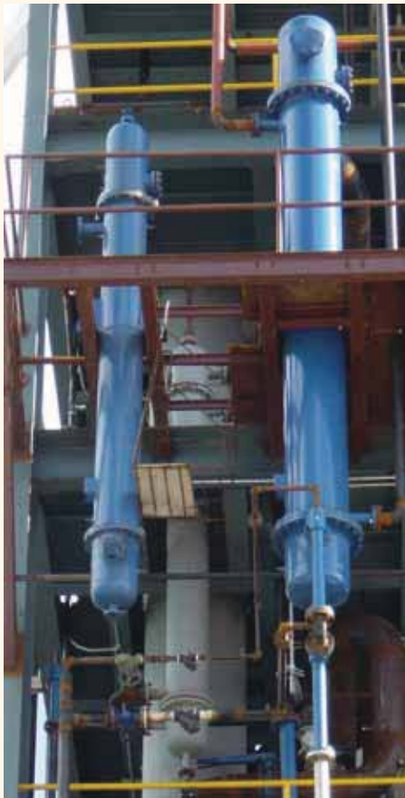
CONDENSADORES VERTICALES CON SISTEMA DE LAVADO VERTICAL CONDENSERS WITH CLEANING SYSTEM
